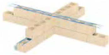
Armadura de Tendel
