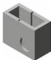
Imbornal Hormigón en masa
